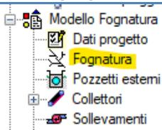
Una volta modellato il territorio, in modo da aver definito le quote altimetriche su tutta la superficie, è possibile passare alla modellazione della rete fognaria. Per cominciare la modellazione è necessario accedere alla vista grafica della rete. Selezionare il nodo *Fognatura* dall'albero di progetto ed utilizzare il comando "Disegna" dal menù di *Progetto*.
