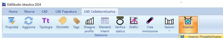
Dal menù utilizzare il comando "Inserisci PozzettoFogna" ed indicare un punto sul collettore selezionato. Se non è stato indicato un vertice verrà richiesto il valore della progressiva e confermando apparirà il pozzetto sul collettore nella posizione indicata.
