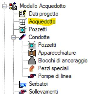
Una volta modellato il territorio in modo da aver definito le quote altimetriche su tutta la superficie è possibile passare alla modellazione della rete idrica. Per cominciare la modellazione è necessario accedere alla vista grafica della rete. Selezionare il nodo *Acquedotto* dall'albero di progetto ed utilizzare il comando "Disegna" dal menù di *Progetto*.
