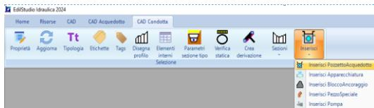
Dal menù utilizzare il comando "Inserisci pozzetto acquedotto" ed indicare un punto sulla condotta selezionata. Se non è stato indicato un vertice verrà richiesto il valore della progressiva e, se confermato, apparirà il pozzetto sulla condotta nella posizione indicata.
