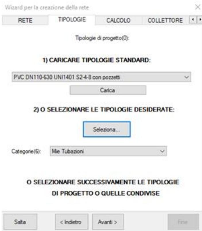
Nella **scheda Tipologie** l'utente può immediatamente selezionare le tipologie da utilizzare per la creazione del modello di rete. La prima opzione "Carica" è comoda per fare le prime prove, la seconda "Seleziona" consente di esplorare le tipologie presenti nella cartella di installazione, altrimenti è possibile rimandare tale scelta ad un secondo momento.
