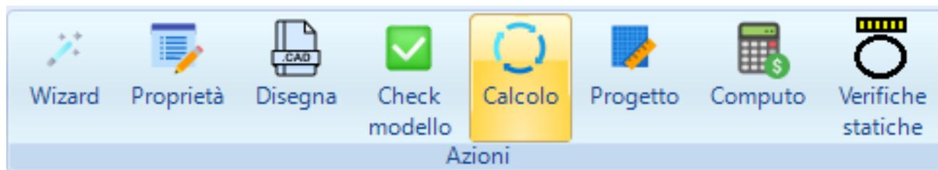
Per lanciare il calcolo dal nodo ReteIrrigua cliccare sul comando “Calcolo” che visualizza una scheda in cui sono contenute alcune variabili utili per il calcolo (come la formula di resistenza, la precisione) e per le verifiche (pressioni e velocità minime e massime).
