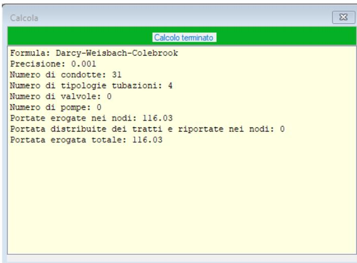
Sempre dal menù della scheda di calcolo è possibile eseguire il comando “Risultati” che consente di visualizzare in una lista i risultati dell’elaborazione, forniti in tutti i vertici delle condotte.
