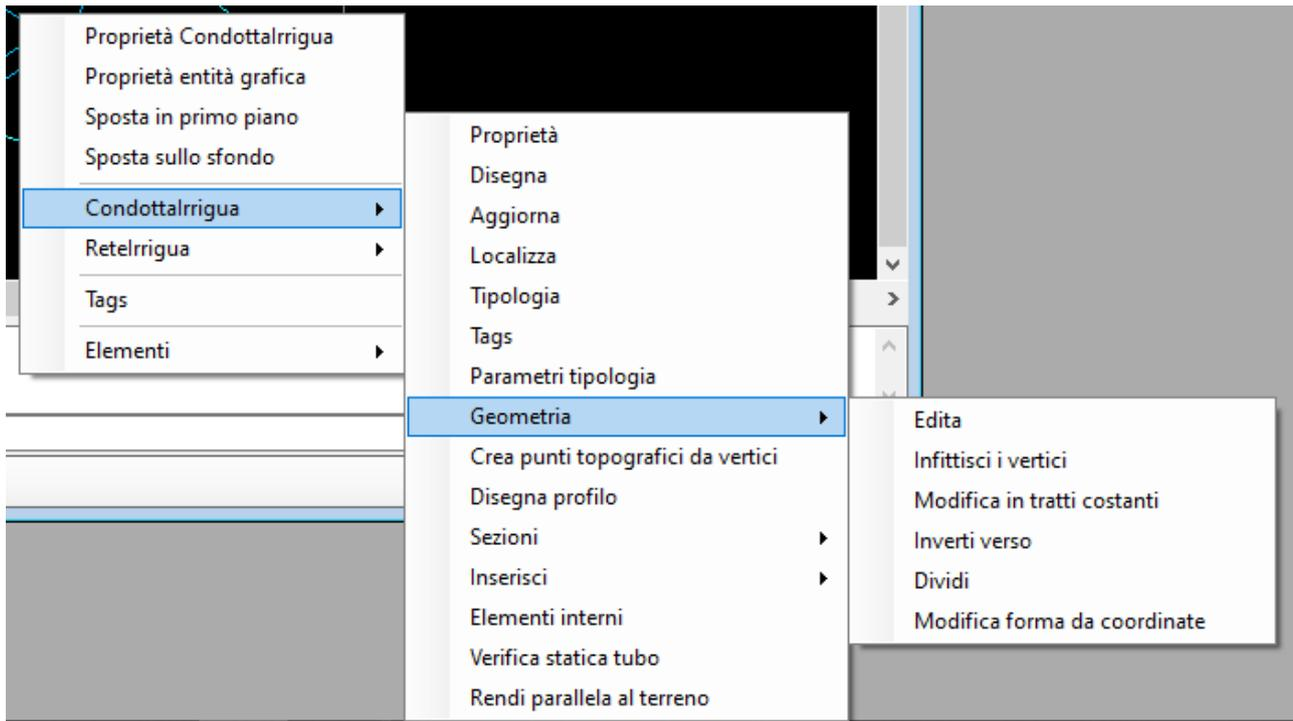
Ad esempio, è possibile invertire il verso della condotta se è stato immesso non correttamente, con il comando "Geometria->Inverti Verso".
