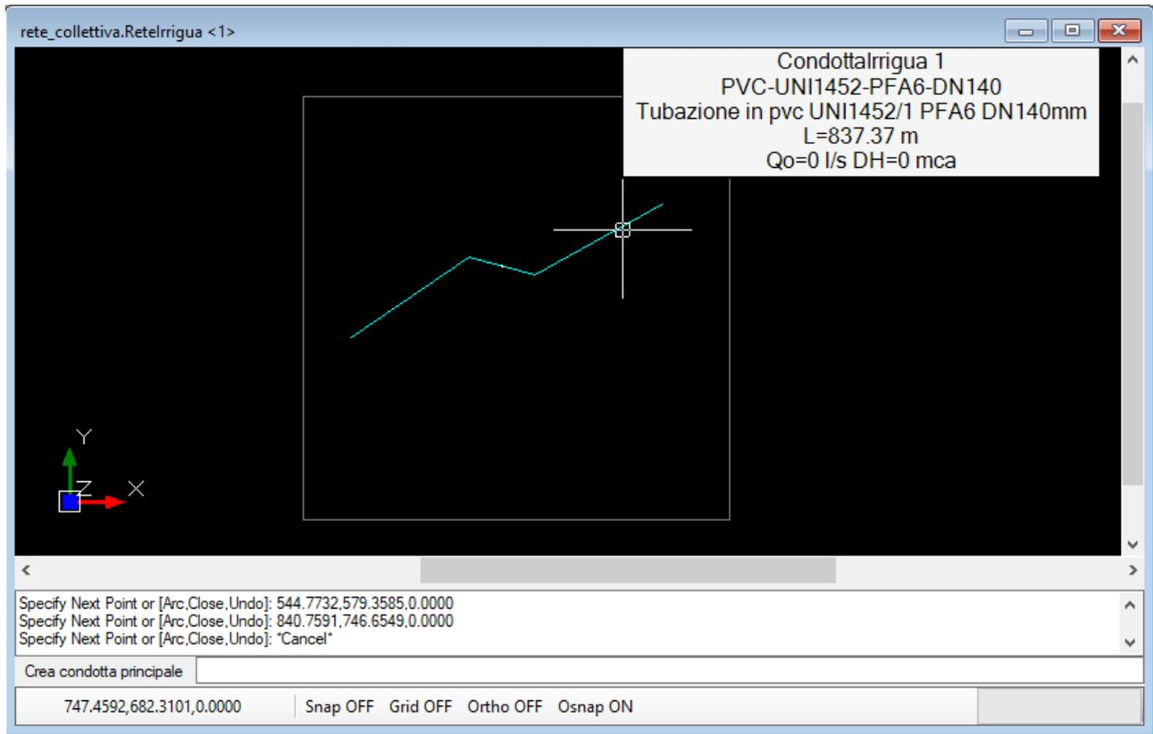
Una volta disegnate una o più condotte è possibile selezionarne una in modo da fa apparire il menù “CAD Condotta” nella barra principale.
